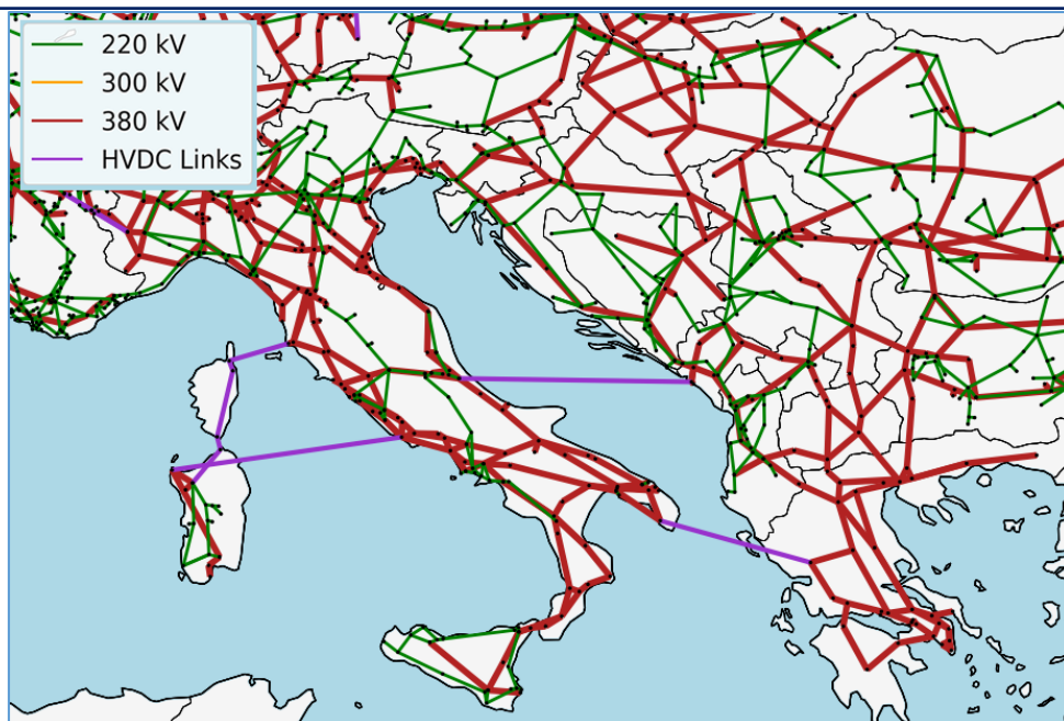
Slika br.1.11. Mreža elektroenergetskih vodova (220 kV, 300 kV, 380 kV i vodovi jednosmjerne struje HVDC) području južne Evrope, sa uočljivom kvalitetnom povezanošću Crne Gore sa širim okruženjem kopnom i podvodnom mrežom (Cavalieri et al., 2014).
